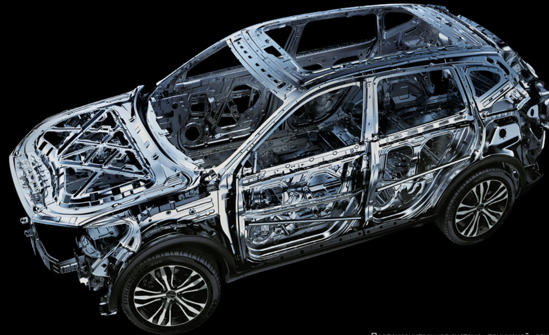
Предохранительная система «панцирной» защиты. Салон автомобиля опоясывает каркас безопасности, созданный из высокопрочной стали
